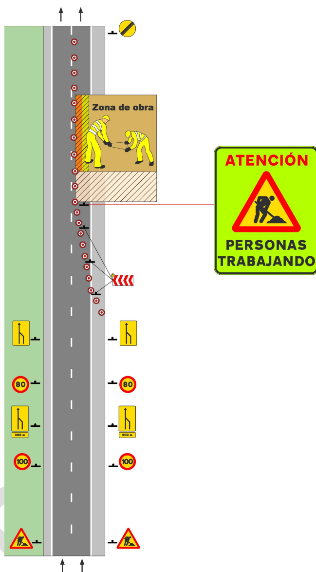
Figura 4: Señalización de presencia de trabajadores
